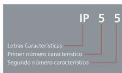
Figura.2.29 Tipo de código en grado de protección IP.
