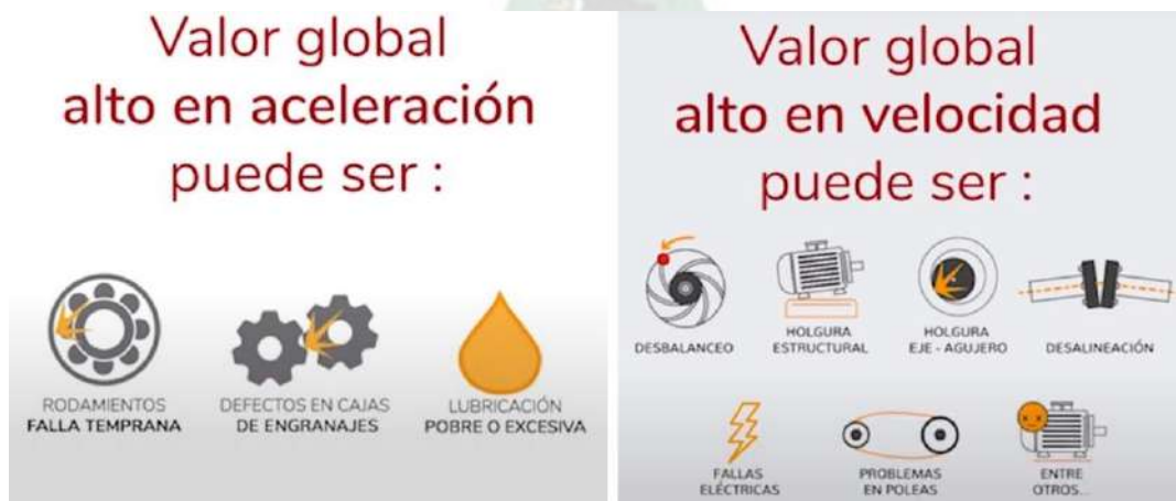
Figura.3.20 Valores de vibración relacionados a fallas.
