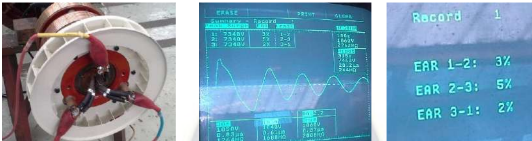
Figura 4.5 Prueba surge con anillas conectadas - motor 531.MD140.M01
