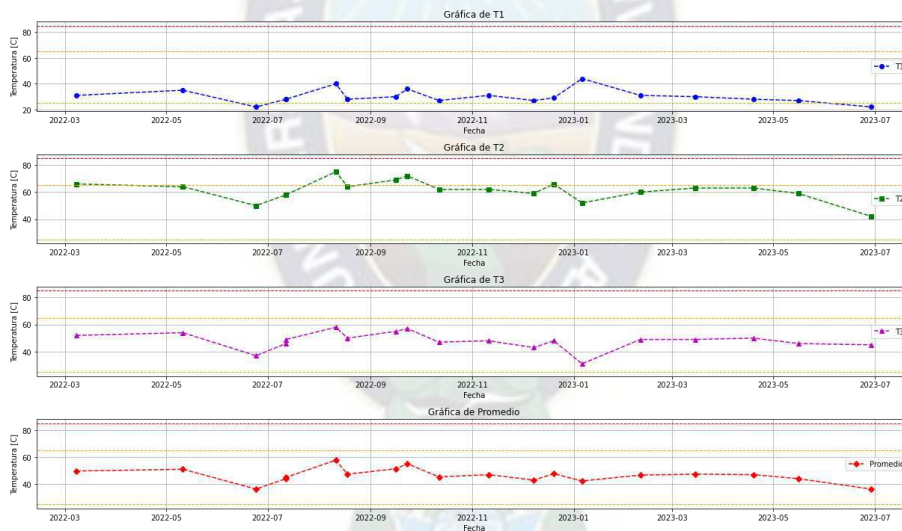
Gráfico 4.22 Curvas del comportamiento térmico – motor 531.MD140.M01
