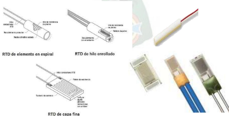
Figura.3.14 Estructura de los RTDs.
