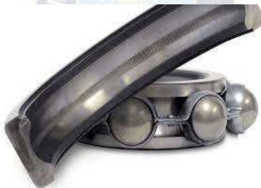
Figura 3.4 Fluting - Erosión eléctrica en rodamientos
