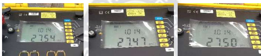
Figura 4.2 Medición de resistencia de bobinas – motor 531.MD140.M01
