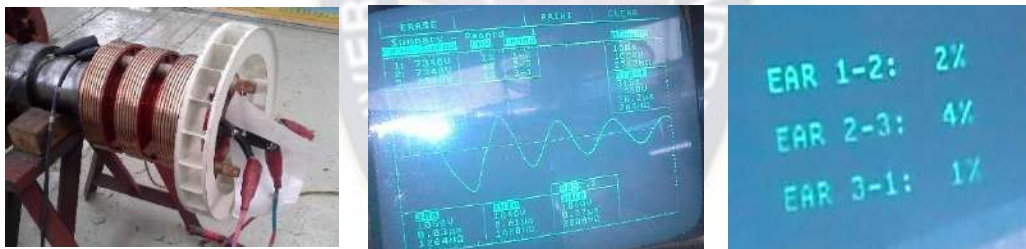
Figura 4.6 Prueba surge con anillas desconectadas - motor 531.MD140.M01
