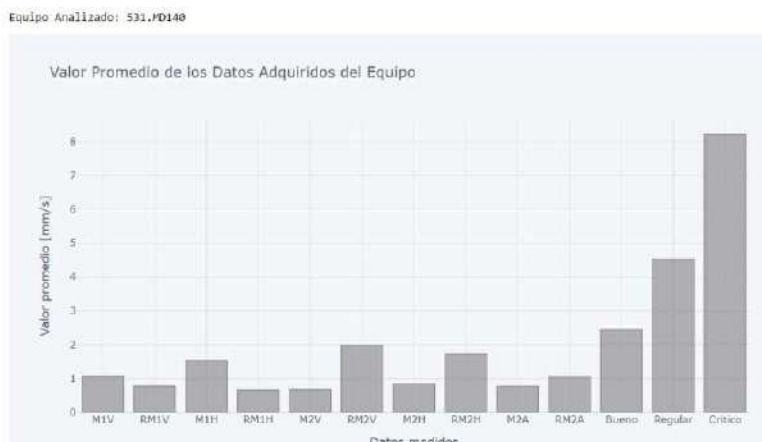
Gráfico 4.12 Subplots de Vibraciones Globales por puntos – 531.MD140 (2018-2019)
